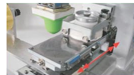
Movimiento de la plataforma entrada/salida (limpieza del tampón por debajo)
